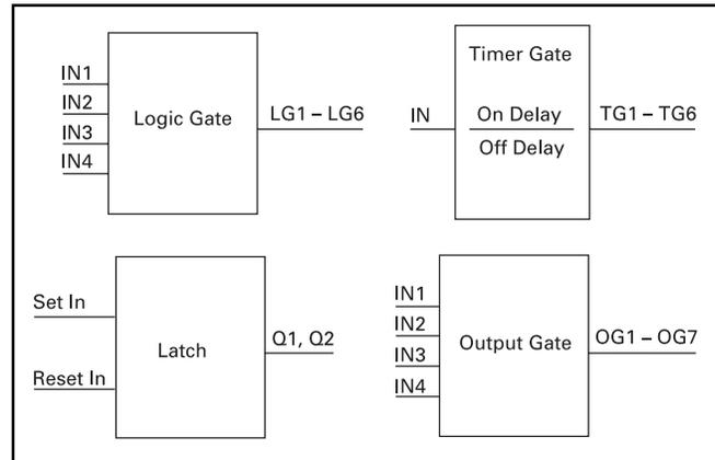
**Figure 9-3. Programmable Logic Elements**
